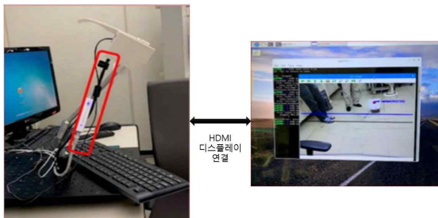
그림 2. 스마트 안경과 HDMI 디스플레이간 연결
